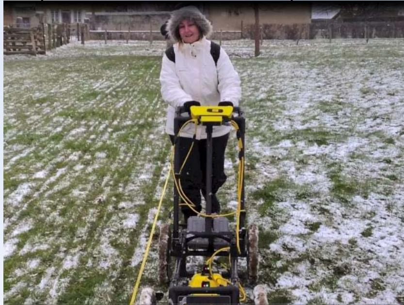
L'appareil émet des ondes à hautes fréquences dans le sol. Celle-ci sont renvoyées par les corps rencontrés.
